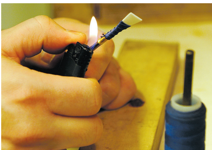
Auch die Doppelrohrblätter stellt der Instrumentenbauer selbst aus Schilf oder Kunststoff her. Sie werden in ähnlicher Bauart auch bei Fagott oder Oboe verwendet und erzeugen den Ton in der Spielpfeife.
